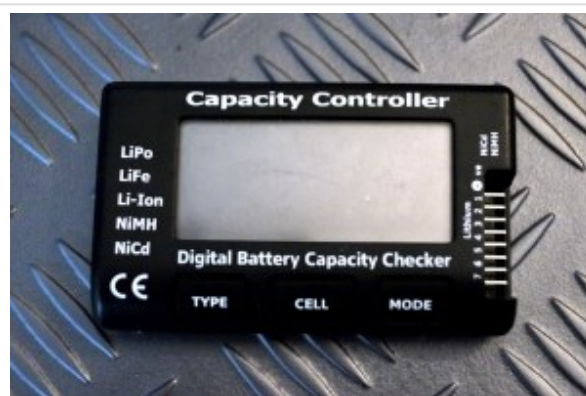
Contrôleur Lipo qui vous permettra de mesurer le voltage
