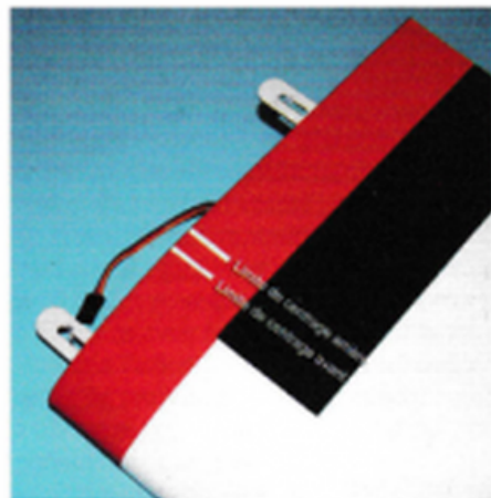
De petites bandes d'adhésif collées à l'intrados ou à l'extrados permettent de "sentir" les limites de centrage quand on souève l'avion sur les doigts.
