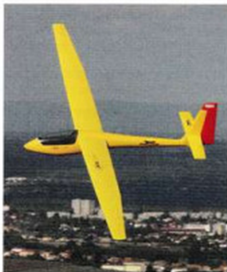
L'ASW 15b est un planeur maquette typique des fuselages à avant plongeant. En palier, la poutre arrière est horizontale, mais la forme du nez donne une fausse impression de voler queue haute.
