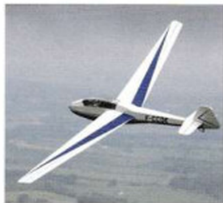
Cas typique d'aile en flèche inverse sur ce Borgfalke : le centrage reporté sur l'emplanture va être très proche du bord d'attaque, et c'est normal !
