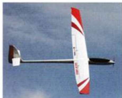
Les planeurs non maquette taillés pour la perfo volent avec un fuselage parfaitement à l'horizontale, pour une traînée minimale.
