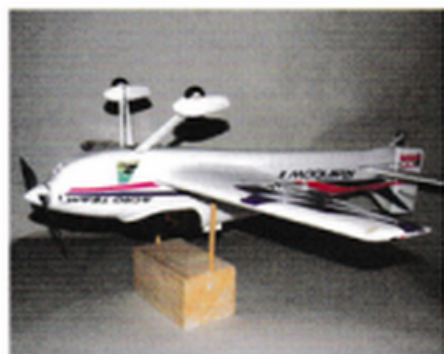
L'avion est posé sur un support d'équilibrage au niveau des marques de position du centre de gravité. Il est plus facile de le faire en retournant l'avion quand on a une aile basse.
