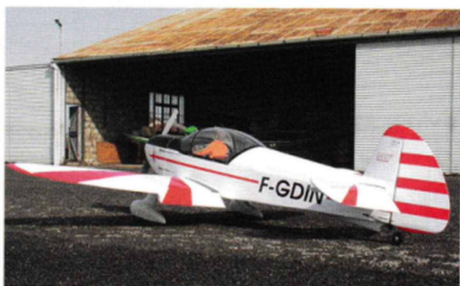
Le Cap 10 est un bon exemple de modèle qui ne doit pas être centré «au tiers»... Son stab n'est pas très grand, il vole sainement centré entre 25 et 27 % de la corde moyenne.
